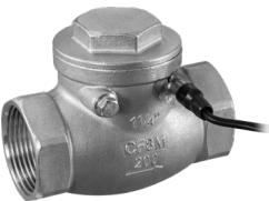
Принцип работы датчиков-реле основан на отклонении лепестка внутри прибора. Лепесток смещается под действием давления потока жидкости в труbe и замыкает контакты геркона. В случае отсутствия потока в трубе лепесток возвращается в исходное положение под действием силы тяжести, что приводит к размыканию контактов. Направление движения потока должно соответствовать стрелке на корпусе датчика-реле.
